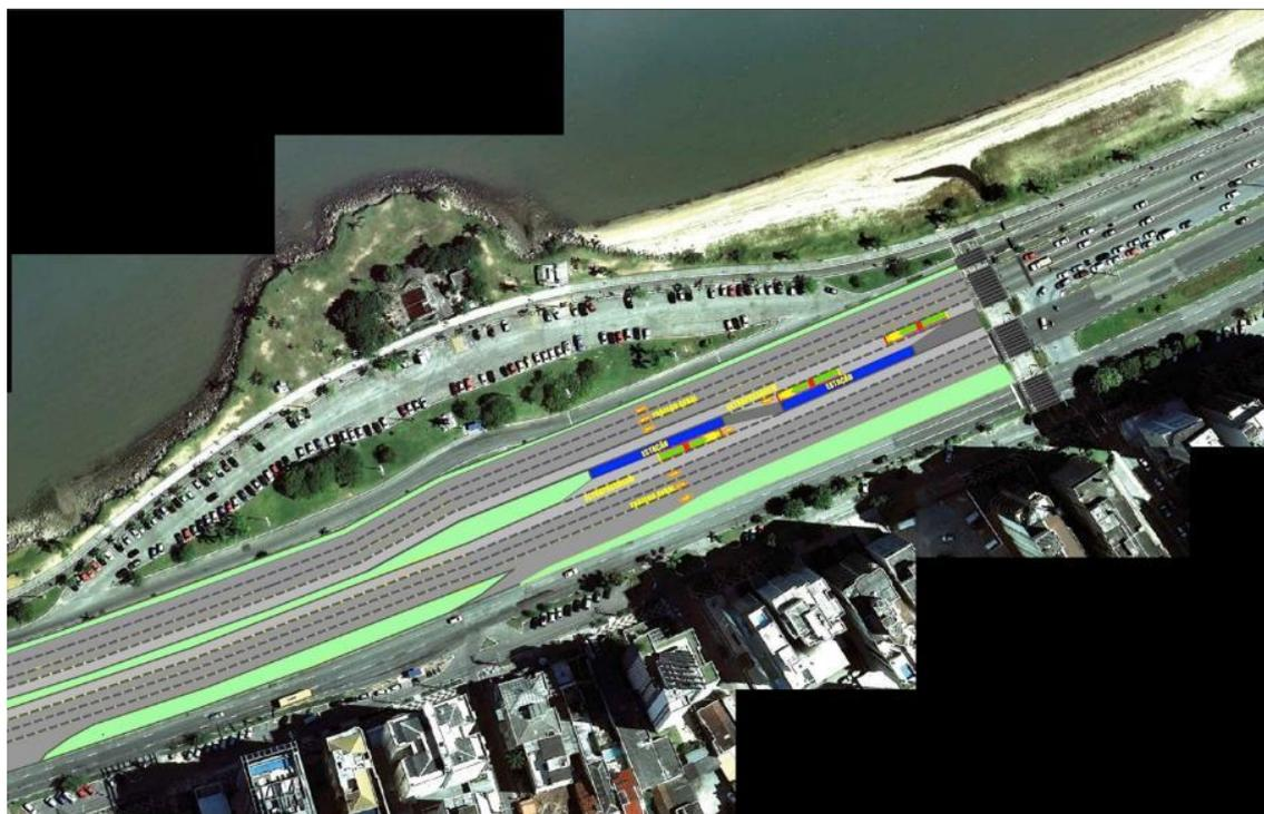
**Figura 10-3 – Exemplo ilustrativo de estação de BRT dupla na Av. Beira Mar**
