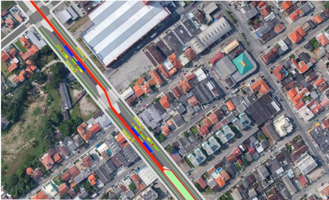
**Figura 10-6 – Exemplo ilustrativo de estação de BRT dupla na Av. das Torres**
